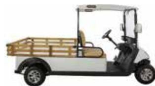
·Shuttle A/B 木货箱 木货箱尺寸: 1505*1180*310mm
